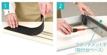
取付台ベースに滑り止めシートを貼り付けます。標準取付枠に取付台ベースを取り付けます。
