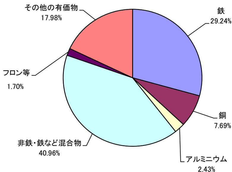
冷蔵庫・冷凍庫の材料構成比
