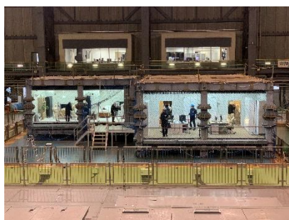
震動台に構築した試験体
